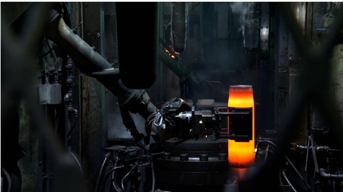
*Un proyectil de artillería de 155 mm moldeado dentro de la planta de municiones del ejército de Scranton. (CNN)*
