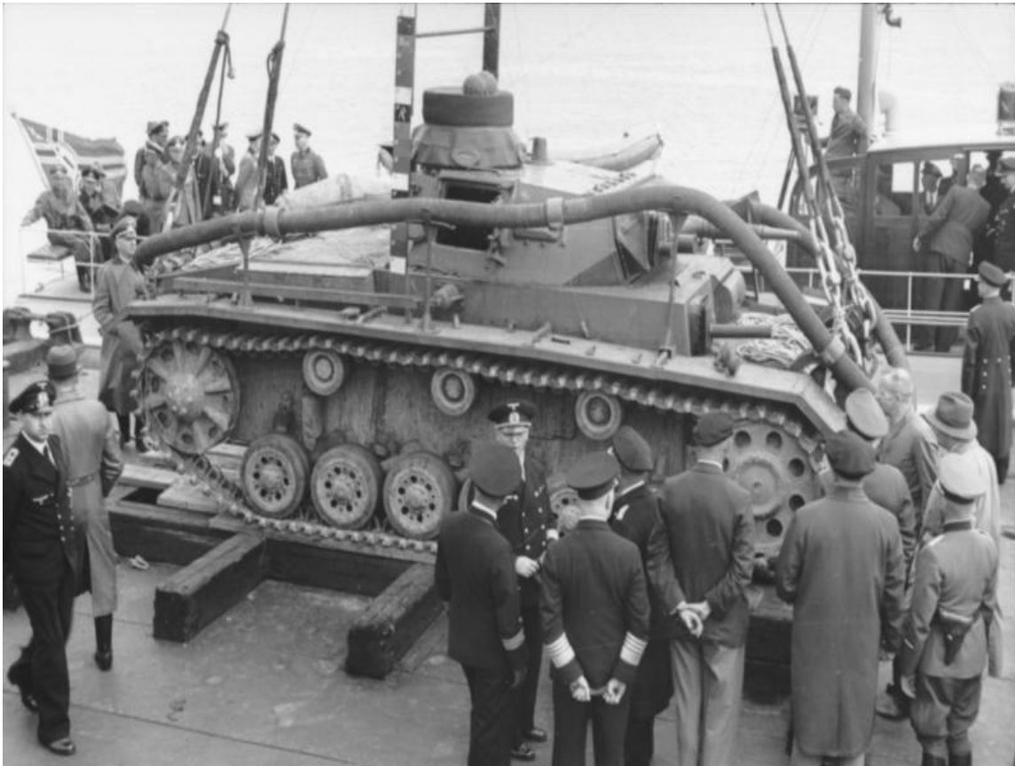
Tauchpanzer III, adaptación para combate anfibio del Panzer III. Pensado para poder sumergirse completamente, cubría todas las ranuras del Panzer III con un compuesto impermeable y protegía el espacio entre la ranura y el casco con una goma inflable. Una manga flexible de 18 m fijada a una boya debía mantener el flujo de aire en el interior. Estaba diseñado para poder sumergirse hasta 15 m de profundidad por un tiempo máximo de 20 minutos, tiempo en el que, de acuerdo con los planes de León marino, debían recorrer la distancia hasta las playas de desembarco después de haber sido depositados en el lecho marino por navíos alemanes. Se fabricaron un total de 168 Tauchpanzer III a partir de modelos anteriores, que descartada León marino hubo que readaptar de nuevo para el cruce de ríos, cometido en el que se emplearían durante la Operación Barbarroja. Bundesarchiv, Bild 101II-MW-5674-33 / Engelmeier / CC-BY-SA 3.0.
